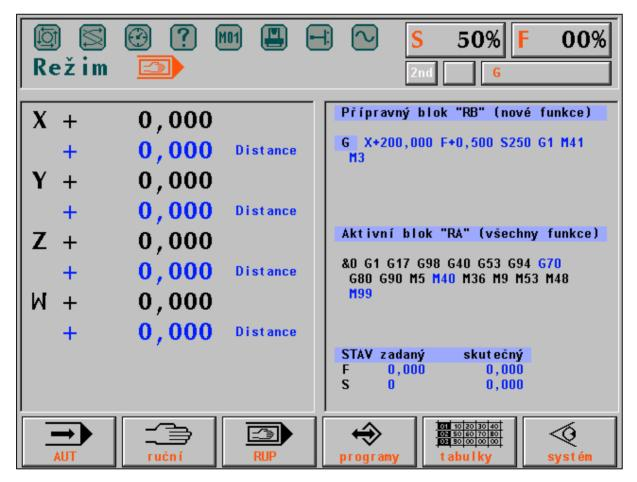
Režim – mode nové funkce = new functions všechny funkce = all functions skutečný = true programy = programs systém = system přípravný blok = preparing block aktivní blok = active block stav zadaný = status entered ruční = manual tabulky = tables The procedure of entry and correction of already entered value may be explained by the following example:
